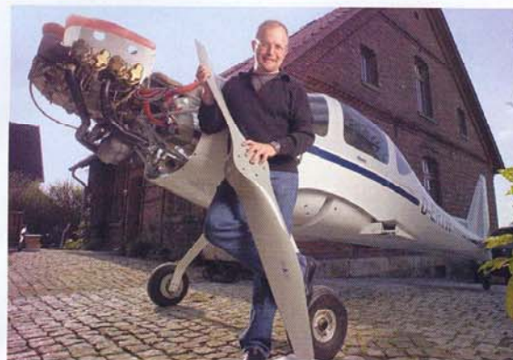
Mit Zweiblattprop und Conti IO-240 hofft Ralf Twellmann den Lärmgrenzwert zu meistern – wenn nicht, kommt noch ein Nachschalldämpfer dran
