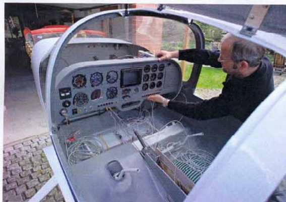
Konventionelle Avionik prägt das Panel der Pulsar 150. Das und Gebrauchtteile hält die Kosten in überschaubarem Rahmen
