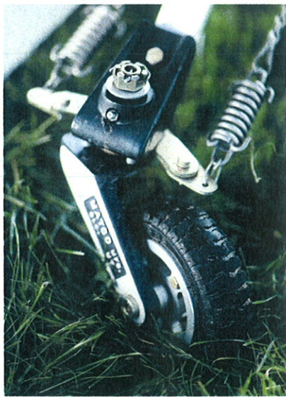
Guter Kitplane-Standard: Das Matco-Spornrad ermöglicht enges Rangieren
